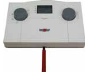
Desmontaje del ART de la base utilizando un destornillador
